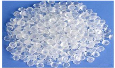
Figure 8: matériau TPE modifié
