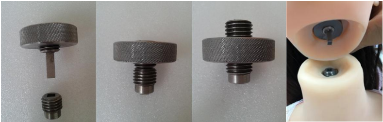
Figure 5: interface mécanique principale (connecteurs)
